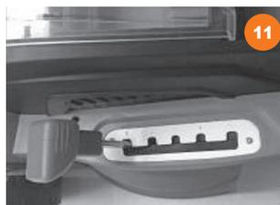
Установите необходимую высоту кошения с помощью рукоятки, выбрав одну из 5 позиций. Высота регулируется в диапазоне от 25 до 75 мм (рис. 11).
